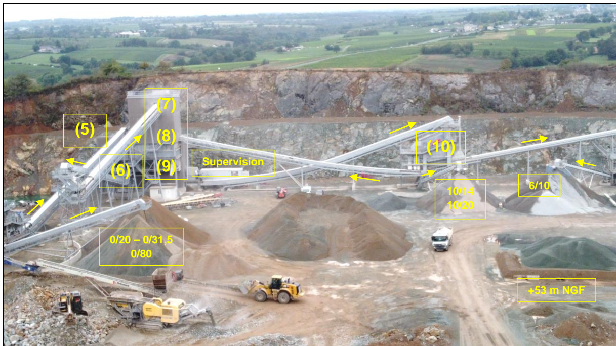
Figure 34 - Vue sur la partie secondaire de l'installation de traitement
