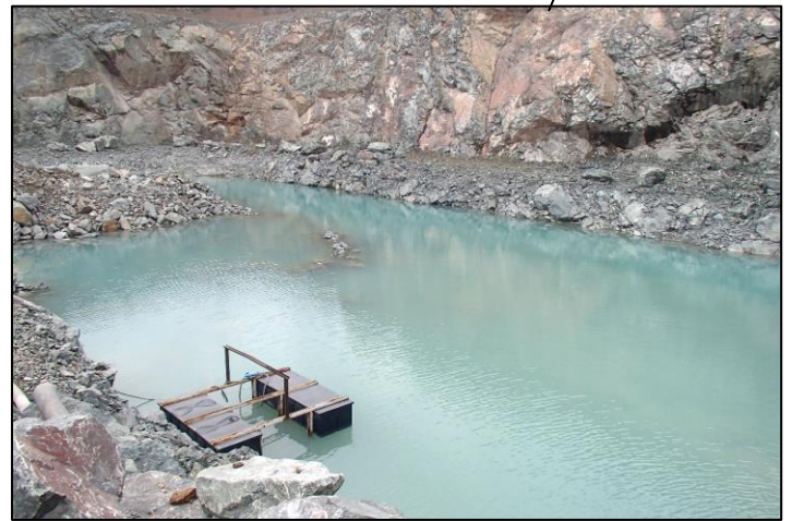
Figure 27 - Bassin de décantation pour l'installation de lavage des matériaux
