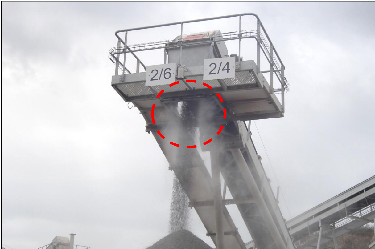
Figure 41 - Brumisation des produits finis en tête de convoyeur
