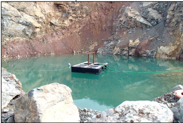
Figure 26 - Bassin de décantation pour l'abattage des poussières sur l'installation de premier traitement
