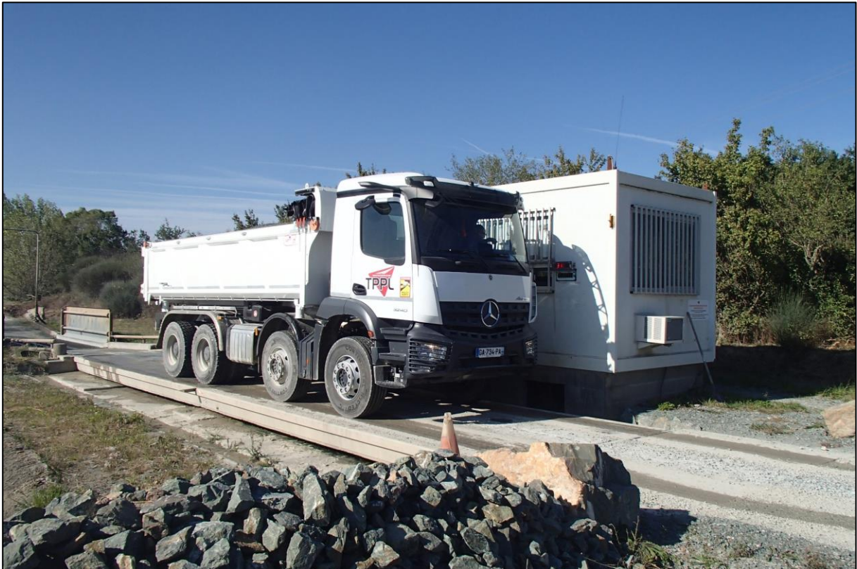
Figure 44 - Pesée d'un camion de commercialisation sur le pont bascule
